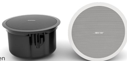
Der FS4CE ist ein Deckeneinbau-Lautsprecher mit einem 4,5 Zoll-Fullrange-Treiber, einer Basswiedergabe ab 70 Hz und einer Empfindlichkeit von 88 dB SPL/1 W bei 1 m.
